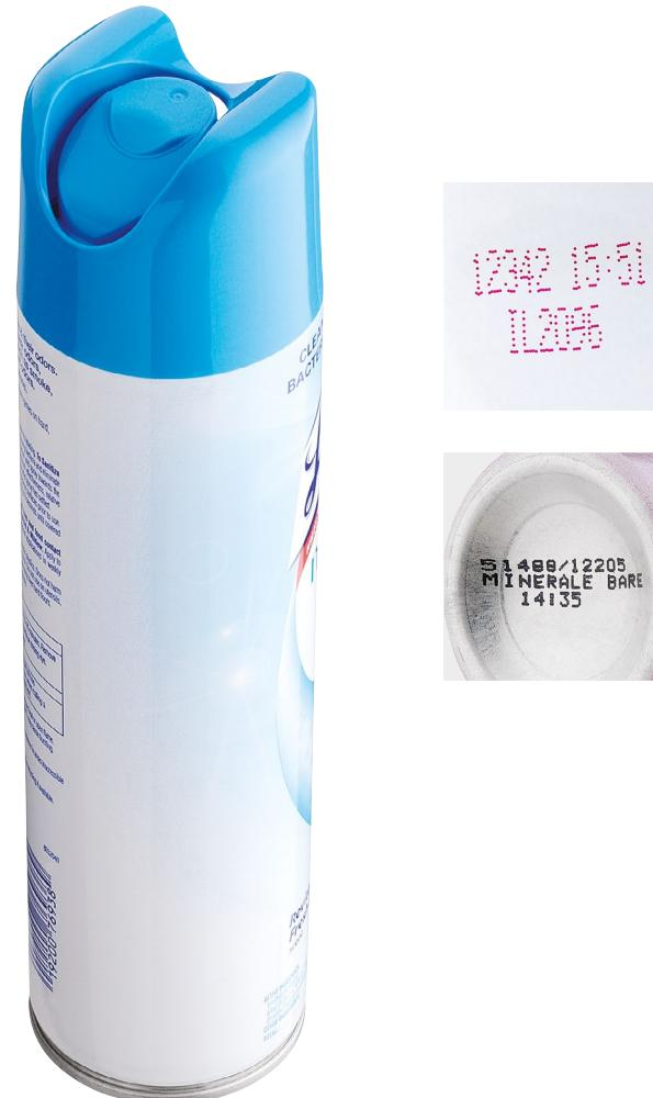
直接在封口件和包装上喷码
